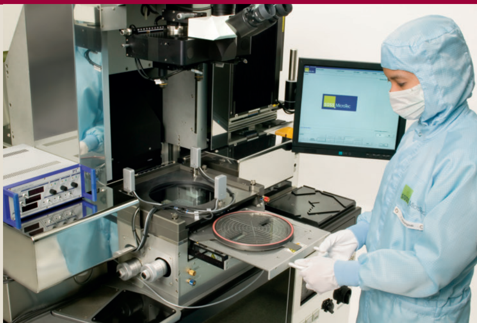
Bild 5. Mask Aligner »MA/BA8 Gen3« von Suss MicroTec mit speziell für Mikrolinsen-Imprint-Lithografie (»Smile«) und das Packaging von Wafer-Level-Kameras entwickelten Modulen
