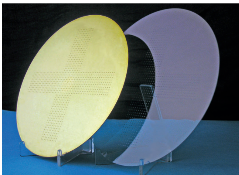
Bild 6. Linsen-Master-Array (8 Zoll) aus Messing von Kaleido Technology und mittels Mikrolinsen-Imprint-Lithografie (»Smile«) repliziertes Mikrolinsen-Array
