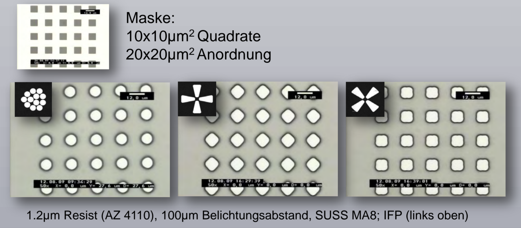
1.2µm Resist (AZ 4110), 100µm Belichtungsabstand, SÜSS MA8; IFP (links oben)
